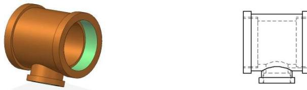
Fig. 4.31 Unión tipo "T" para soldadura de caja
