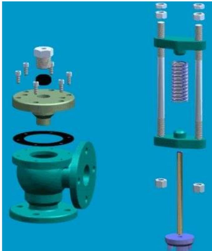
Fig. 4.16 internos de una Válvula de Relevo
