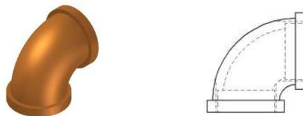
Fig. 4.32 Codo 90° para soldadura de caja
